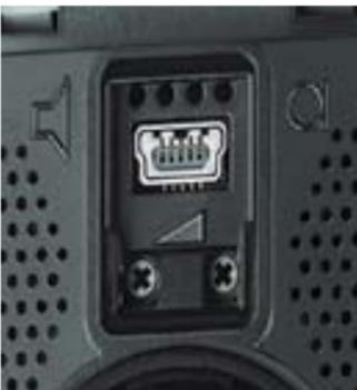
Conexiones mini - USB y regulación del volumen del altavoz y micrófono
