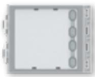
**Módulo de 4 pulsadores aplicados en columna individual.** A utilizar en combinación con los módulos fónicos 351000 - 351100 y los módulos audio vídeo 351200 - 351300. Conexión por medio de cable múltiple incluido. Retroiluminación de las tarjetas portanombre mandada por el módulo fónico o el módulo audio vídeo conectado. Integrable con frontal de acabado.
