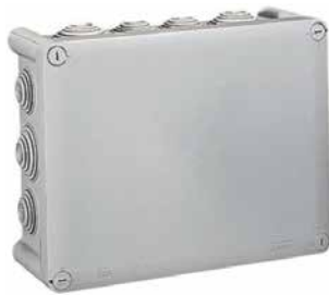
092062 220x170x86mm 14 entradas tipo membrana de 4/32mm.
