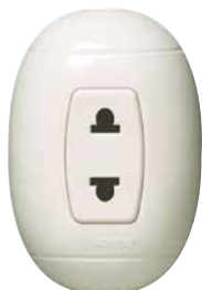
P66 Tomacorriente sencillo, tipo universal, 2P, 16A, 127/250V, 1 módulo
