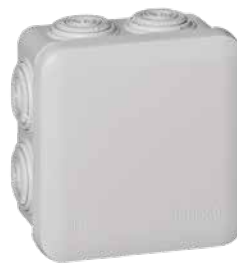
092022 105x105x55mm • 7 entradas tipo membrana de 4/25mm. • Tapa atornillada
