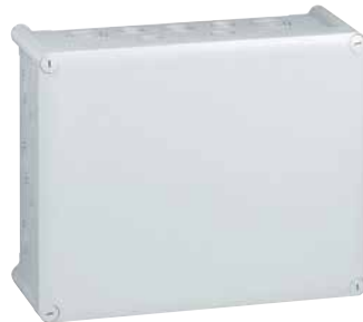
092084 310x240x124mm 2 entradas tipo knock-out de 16/20 mm, 22 de 20/25 mm, 6 de 25/32 mm y 5 de 32/40 mm.
