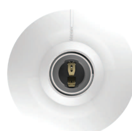
P23B Portalámparas con rosca E27 y sistema de cableado rápido, capacidad de 100W a 127/250Vac - color blanco
